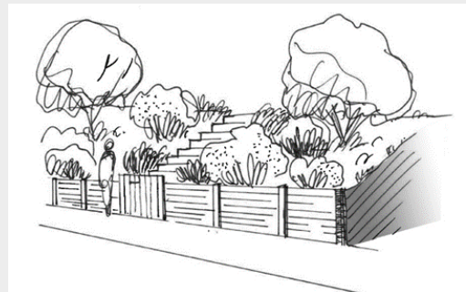
Berlinoise bois en soutènement
